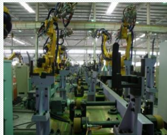
奇瑞165Kg点焊机器人及成线装备
