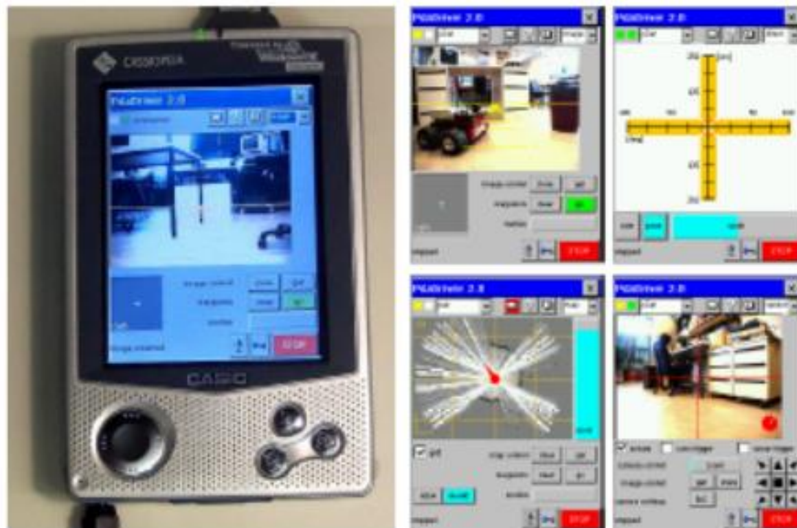
图：卡耐基梅隆大学和瑞士EPFL研制的机器人控制器 (采用卡西欧PDA和Windows CE)
